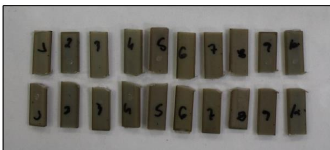
Figura 44 - Corpos de prova da amostra AFK234244 após o ensaio de impacto
