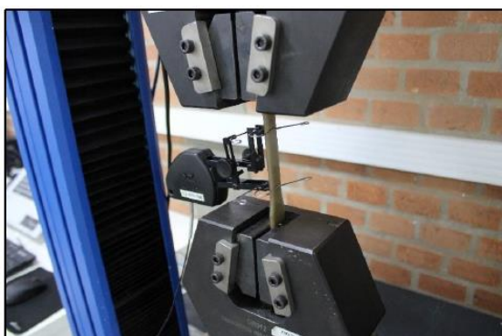
Figura 34 - Equipamento de ensaio a tração Instron EMIC, modelo 23-30
