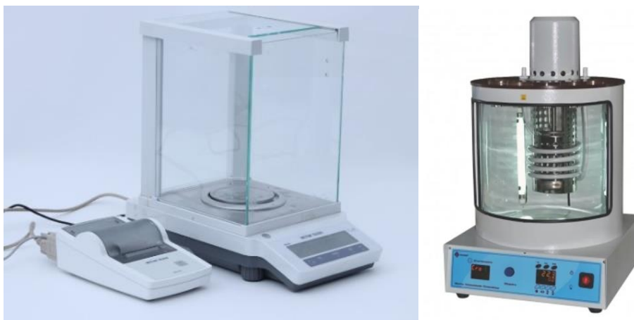
Figura 31 - Balança Analítica Mettler Toledo, modelo ME204/A e equipamento de banho viscosimétrico quimis.
