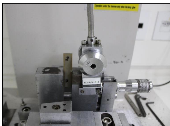
Figura 42 - Corpo de prova da amostra AFK234244 no equipamento de impacto
