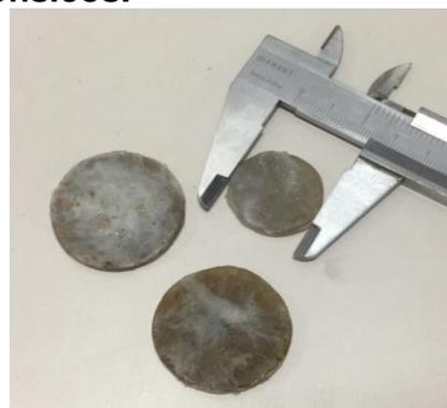
(b) Corpos de prova utilizados nos ensaios termofísicos.
