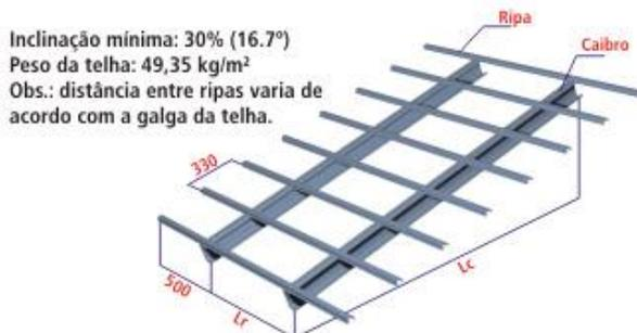
a) Para telhas do tipo cerâmica ou concreto
