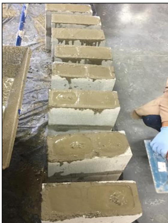
Figura 23 - Grauteamento dos prismas
