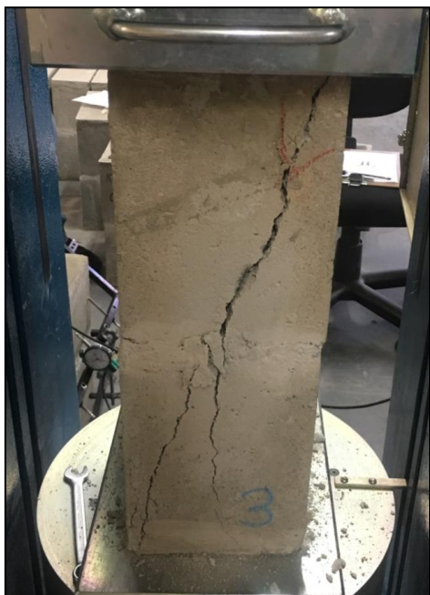
Figura 47 - Prisma com rompimento por compressão
