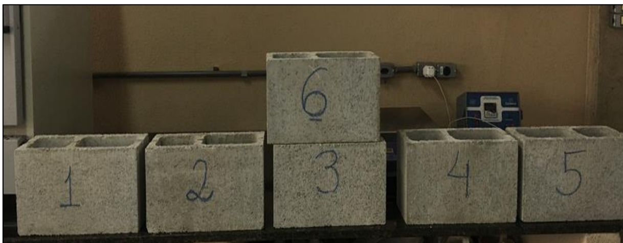
Figura 19 - Corpos de prova para realização da análise dimensional
