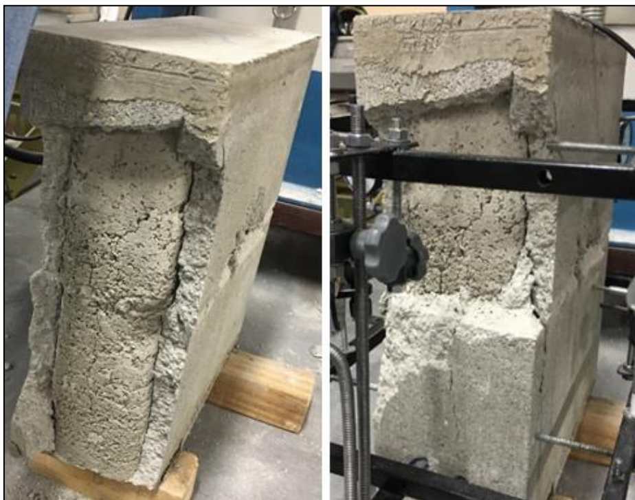
Figura 48 - Prismas com deslocamento das paredes laterais
