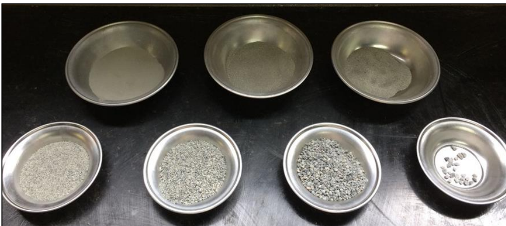
Figura 16 – Amostras do agregado miúdo natural utilizado no ensaio de granulometria
