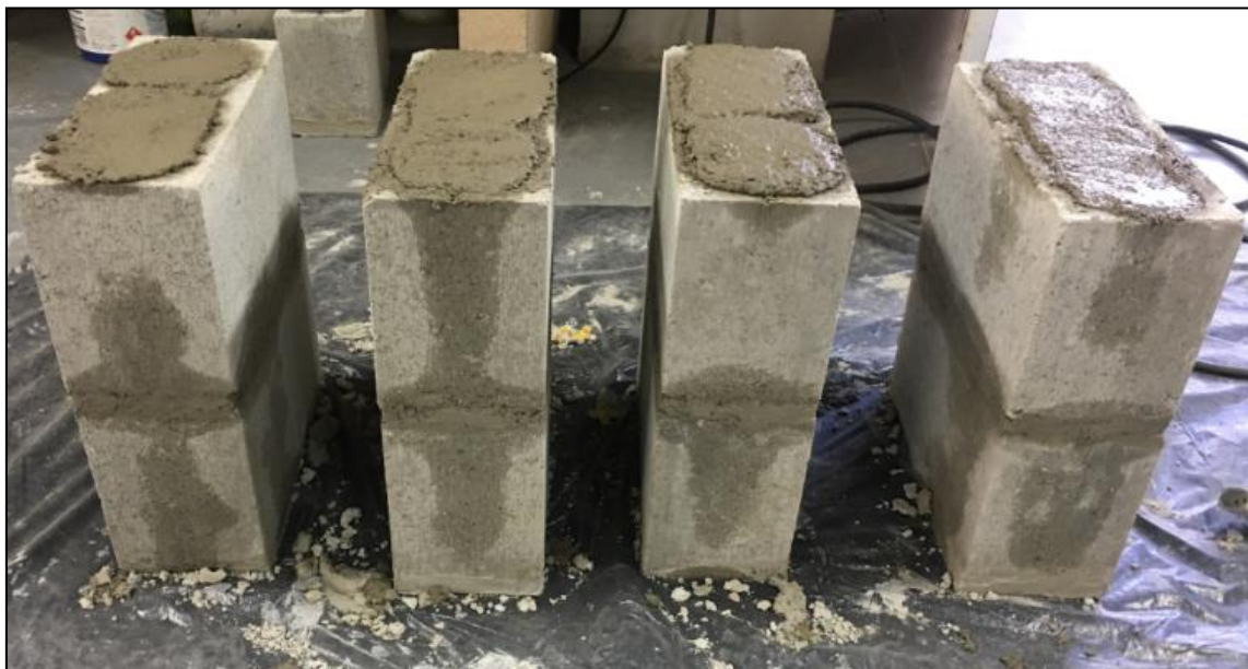
Figura 41 - Absorção da água do graute pelo prisma
