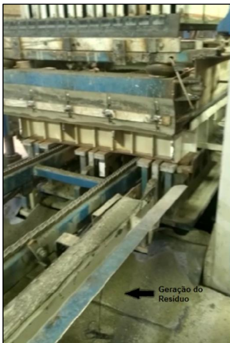
Figura 12 - Resíduos gerados no processo de prensagem dos blocos
