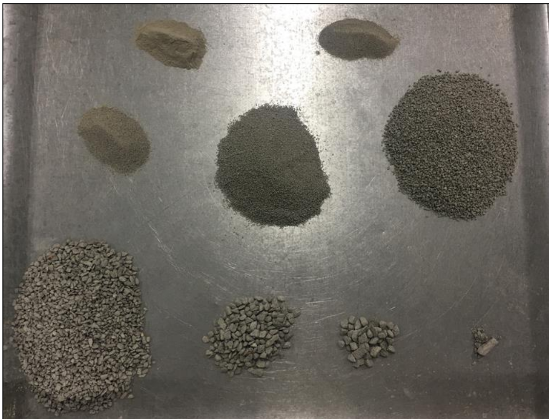
Figura 18 - Amostras do resíduo utilizado no ensaio de granulometria
