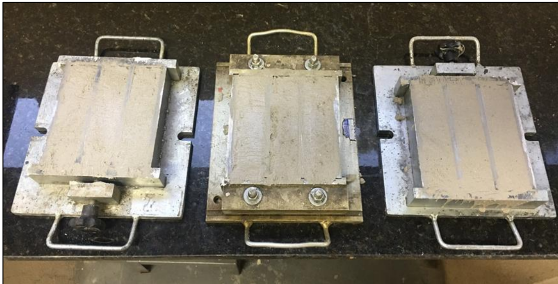
Figura 20 - Moldagem de corpos de prova prismáticos de argamassa
