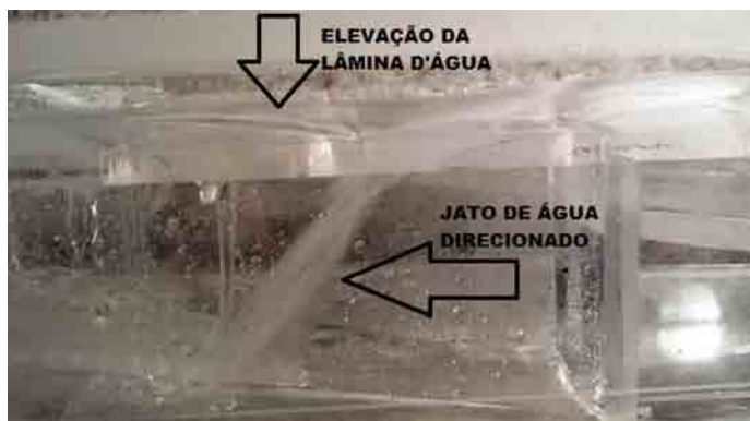
Figura 2 – Visualização do Ressalto na Grelha da Boca de Lobo e Jato Direcionado pelo Impacto do Fluxo na Grelha
