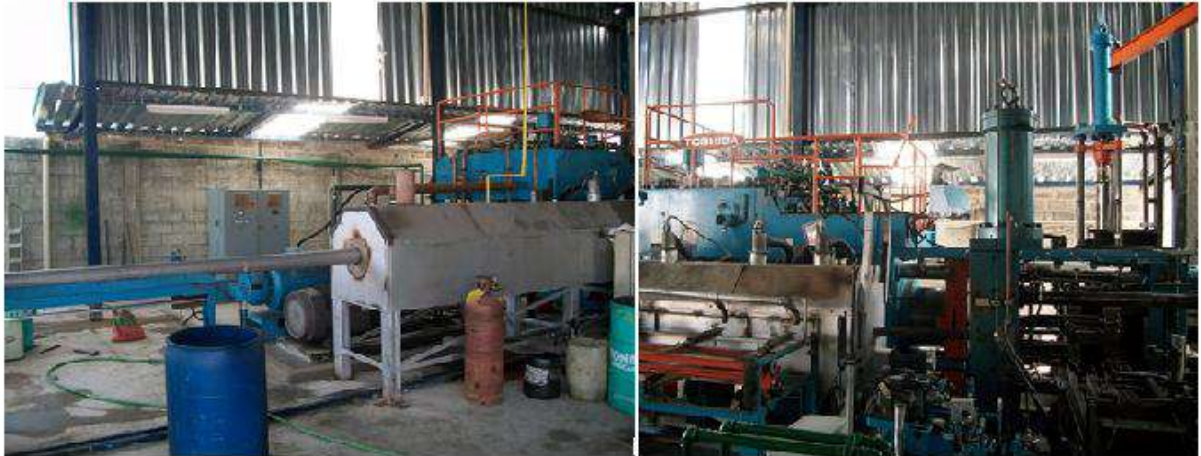
FIGURA 17 - Forno de aquecimento e prensa de extrusão do alumínio
