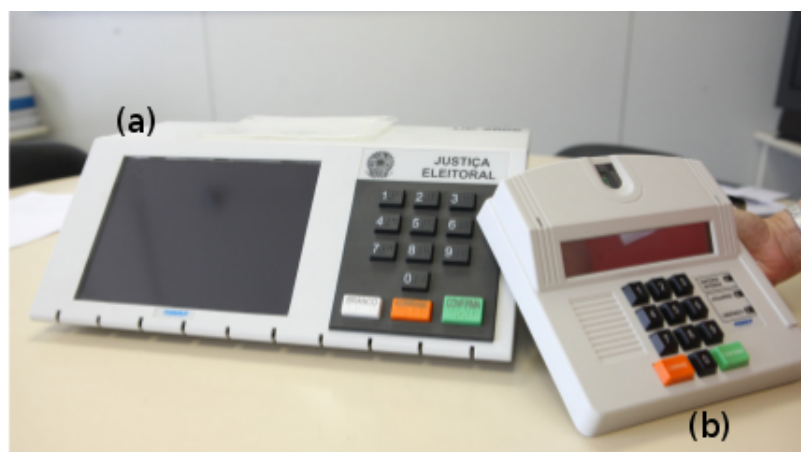
Figura 4 – Urna eletrônica brasileira: (a) terminal do eleitor, (b) terminal do mesário com identificação biométrica do eleitor
