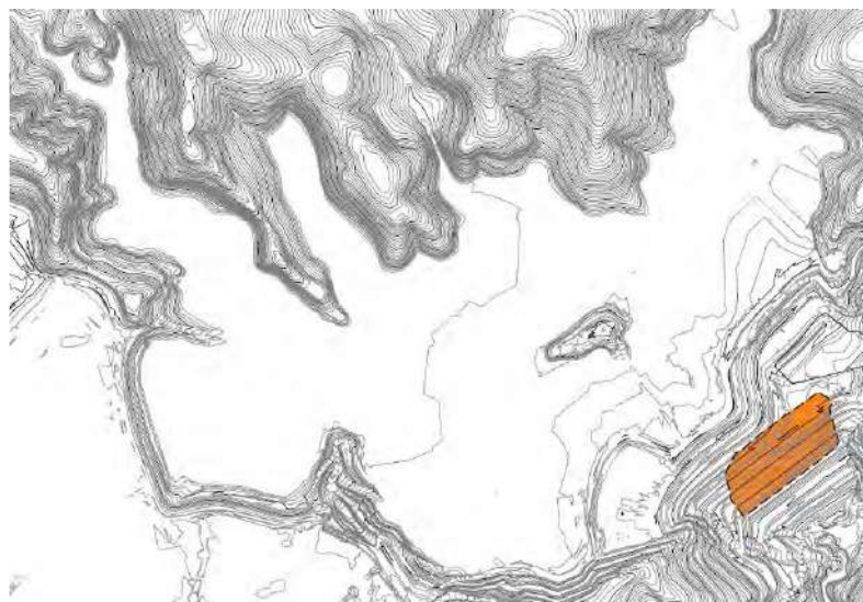
Figura 4 – Configuração em novembro de 2015 mostrando os tapetes drenantes na elevação 826 m e 60 m, barragem alteada, e contorno do reservatório Fonte: MORGENSTERN et al., 2016, p.38.
