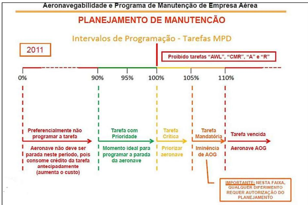
**Figura 18:** Planejamento de parada das aeronaves para manutenção
