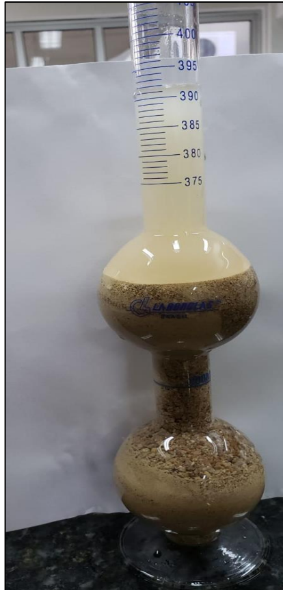
Figura 16 - Frasco de Chapman para determinação da massa específica da areia.
