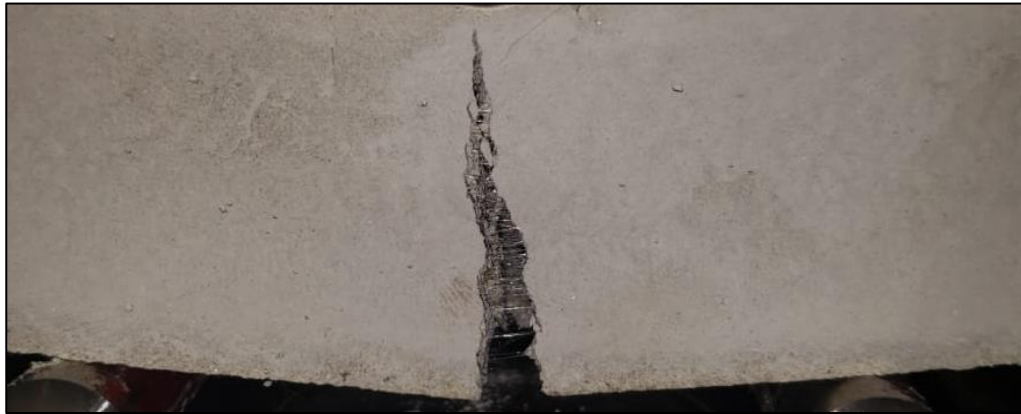
Figura 25 - Corpo de prova sustentado pelas fibras.
