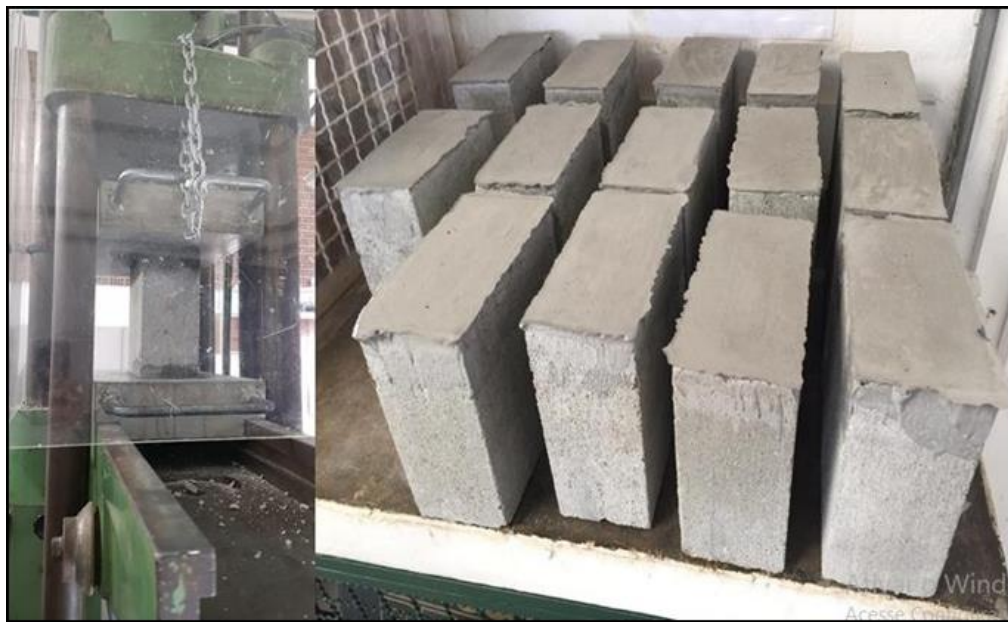
Figura 22 – Ensaio de compressão axial/blocos com a superfície regularizada
