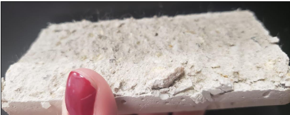
Figura 27 - Corpo de prova tração indireta
