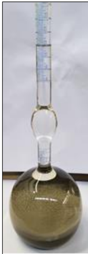
Figura 15 – Frasco Le Chatelier – Para ensaio para massa específica
