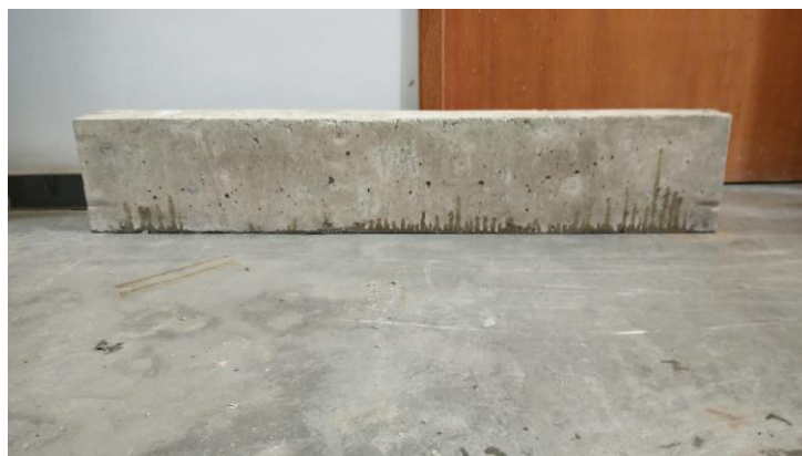
Figura 64 - Fissuração sob carregamento máximo CP 07
