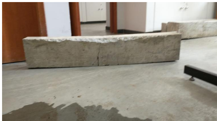
Figura 58 - Fissuração sob carregamento máximo CP 04
