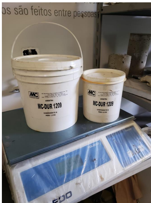
Figura 43 - Resina Epóxi utilizada na colagem dos PRFCs.
