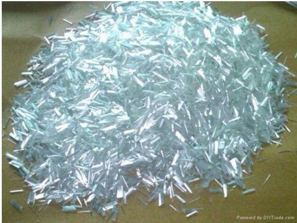
Figura 27 - Detalhe da Fibra de vidro reforçando o concreto
