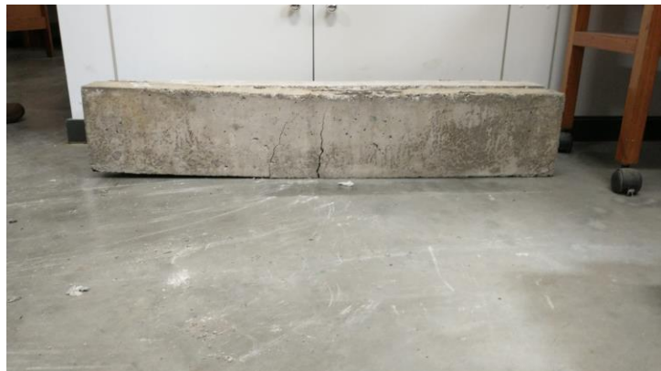
Figura 52 - Fissuração sob carregamento máximo CP 01
