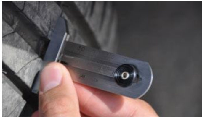
Figura 10 – Medição da profundidade do sulco da banda rodagem de um pneu
