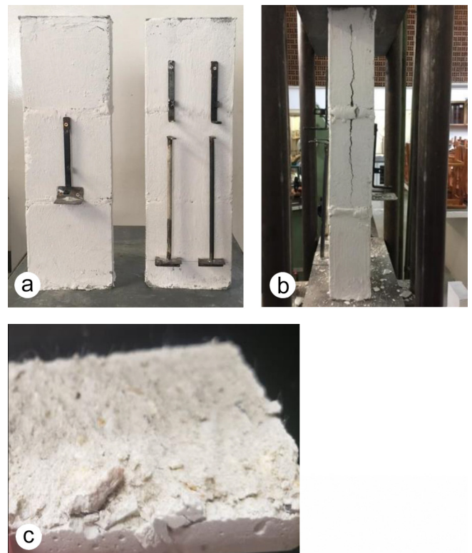
Figura 1: Prismas com três blocos em dimensões reais (a) e (b); argamassa com fibras (c)
