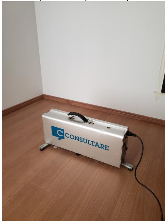
Figura 41 - Fonte de impacto – Máquina de impacto - Tapping Machine
