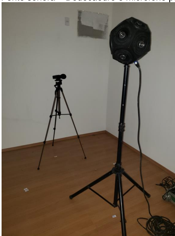
Figura 37 - Fonte sonora – Dodecaedro e microfone para leitura
