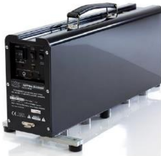
Figura 18 - Máquina de impacto – Tapping Machine
