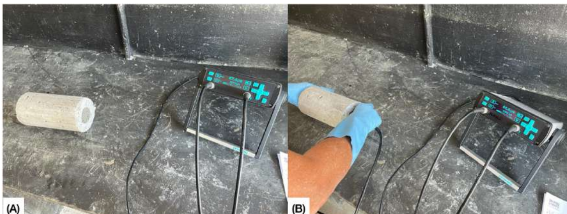
Figura 26: Ensaio de ultrassom - (A) CP preparado com uma fina camada de acoplante e o equipamento; (B) Transdutores acoplados no CP com medição direta.
