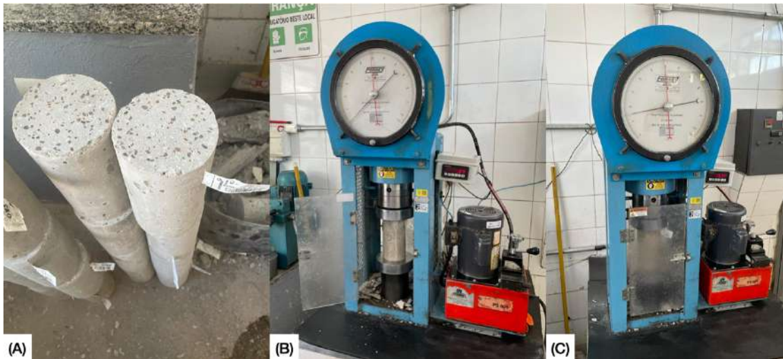
Figura 27: Ensaio de resistência à compressão – (A) Corpos de prova retificados; (B) Prensa hidráulica Forney; (C) Início da ruptura do CP.
