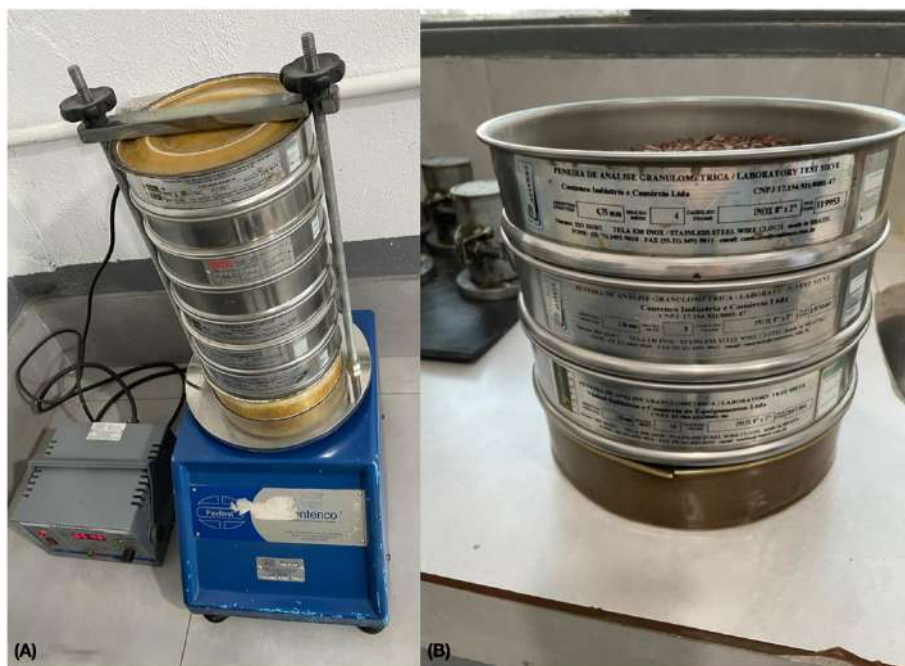
Figura 19: Equipamentos para o ensaio granulométrico da argila expandida (A) Agitador eletromagnético de peneiras e (B) Peneiras.
