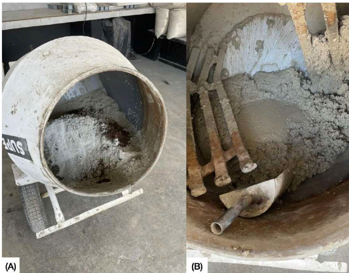
Figura 23: Confeção do bioconcreto – (A) Materiais inseridos na betoneira; (B) Mistura homogênea
