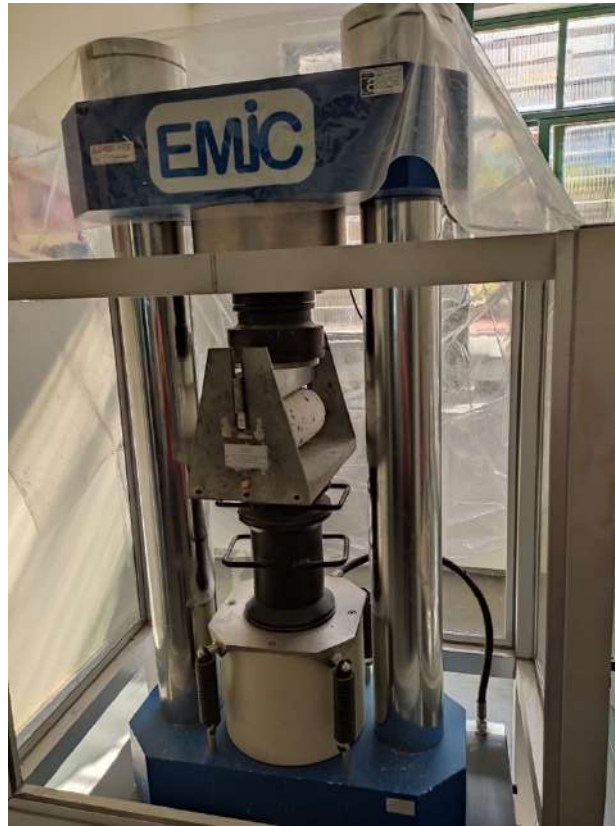
Figura 28: Prensa Universal da marca EMIC utilizada para realizar o ensaio de resistência à tração por compressão diametral.
