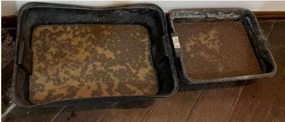
Figura 21: Argila expandida imersa em 500 mL (bacia maior – à esquerda) e 250 mL (bacia menor – à direita) da solução bacteriana.
