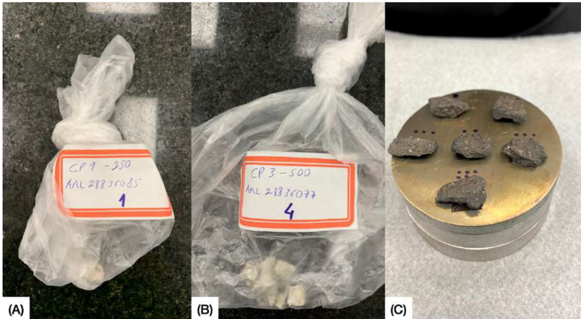
Figura 29: Fragmentos do bioconcreto para análise microestrutural – (A) Traço referente a 250 mL de Serenade; (B) Traço com 500 mL de Serenade; (C) Arranjo para análise.
