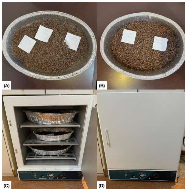
Figura 22: Argila expandida bacteriana: (A) e (B) sem o excesso de líquido; (C) e (D) dentro da estufa.
