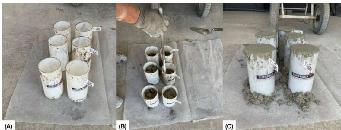
Figura 25: Confeção dos Corpos de Prova (A) Formas para moldagem dos corpos de prova cilíndricos, (B) Confeção dos CPs e (C) CPs moldados.
