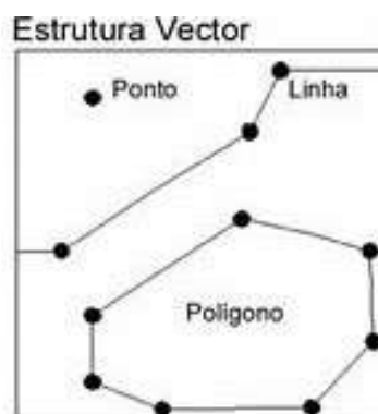
Figura 5 – Representação no modelo vetorial de um ponto, linha e área. Fonte: Saboya (2005).
