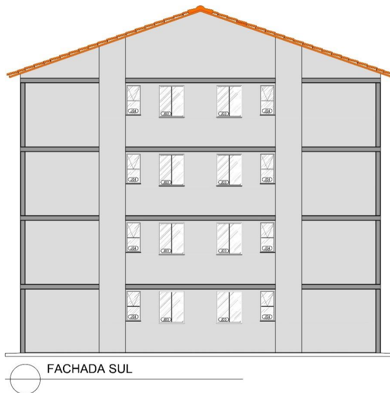
Figura 42: Fachada Sul no sistema de Light Steel Framing
