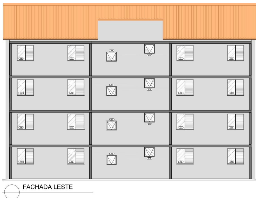
Figura 41: Fachada Leste no sistema de Light Steel Framing
