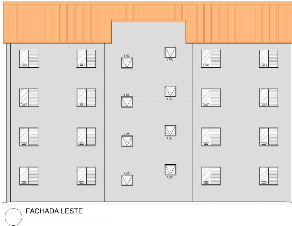
Figura 48: Fachada Leste no sistema de paredes de concreto
