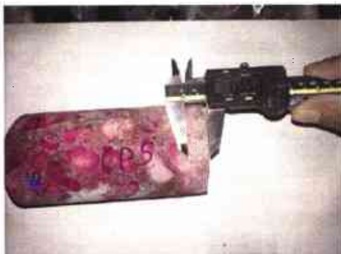
Figura 37 – Corpo de prova após teste em laboratório de carbonatação
